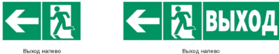
Рисунок 10, лист 1 - Примеры формирования смысловой комбинации знаков для указания направления движения к эвакуационному выходу, средствам противопожарной защиты, месту сбора и средствам оказания первой медицинской помощи
